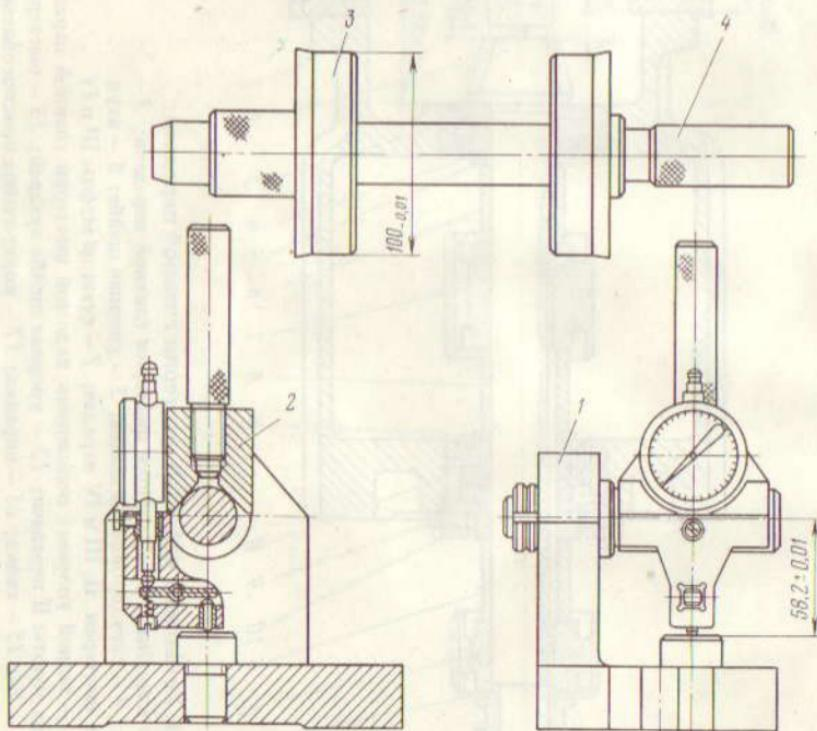
Рис. 95. Контрольное приспособление для подбора толщины регулировочной шайбы:
