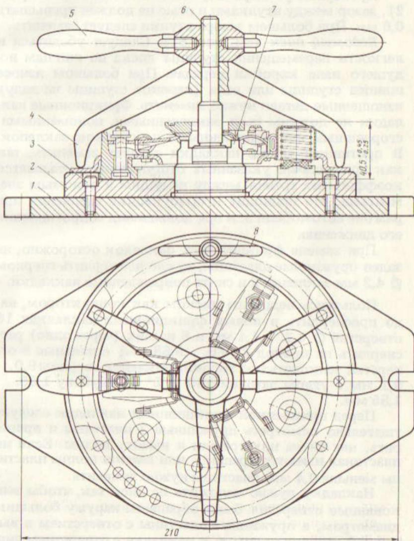
Рис. 82. Приспособление для разработки и сборки муфты сцепления:
