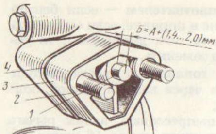
Рис. 75. Выступание штанги привода топливного насоса:
