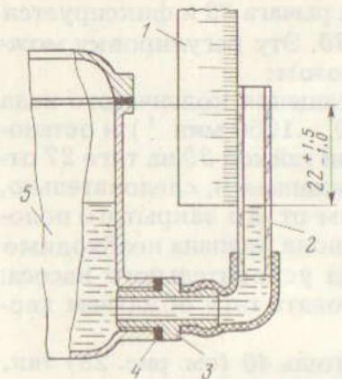
Рис. 78. Проверка уровня топлива в поплавковой камере карбюратора:
