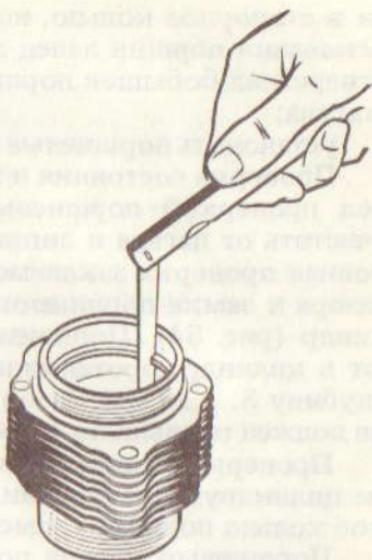
Рис. 54. Проверка теплового зазора в стыке замка поршневого кольца, вставленного в цилиндр
