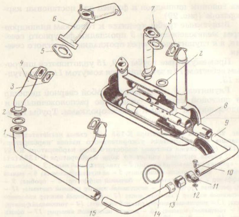
Рис. 29. Впускной и выпускной трубопроводы с глушителем:
