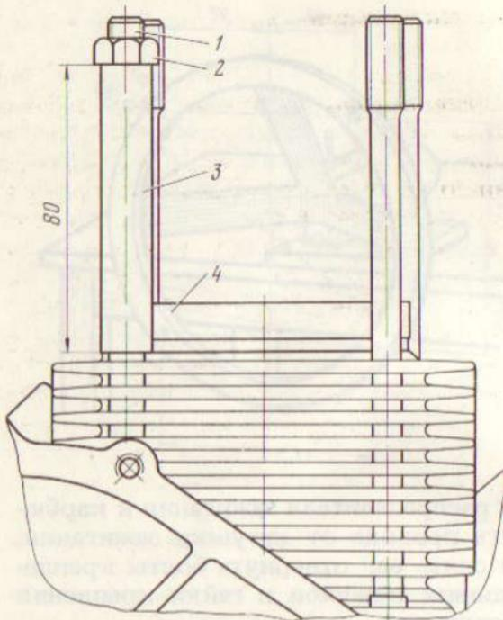
Рис. 34. Крепление цилиндров на картере коленчатого вала:
