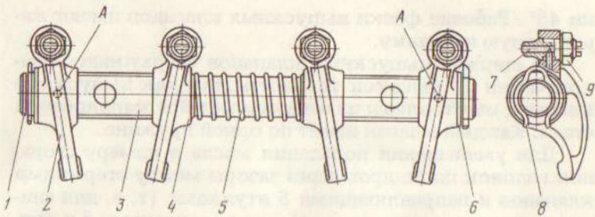
Рис. 16. Валик коромысел клапанов в сборе:
