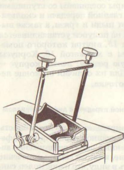
Рис. 90. Приспособление для сборки и разборки коробки передач
