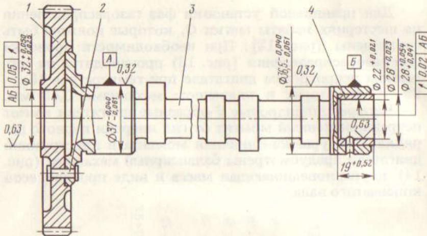
Рис. 11. Распределительный вал в сборе:
