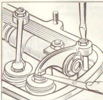
Рис. 43. Регулировка зазора между коромыслом и клапаном
