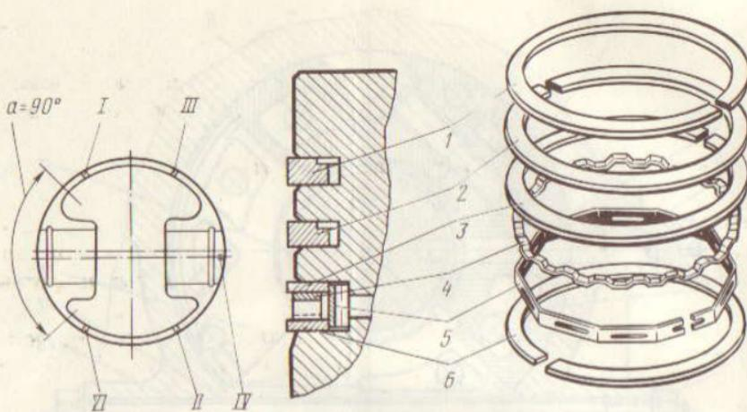
Рис. 7. Расположение поршневых колец на поршне:
