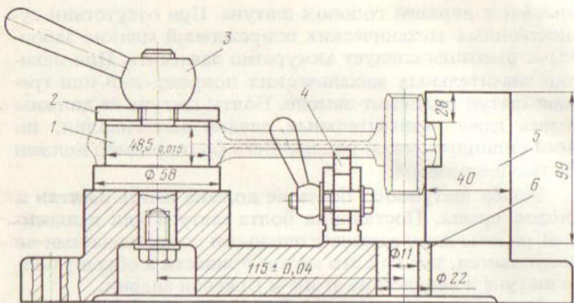
Рис. 58. Приспособление для контроля и рихтовки шатунов:
