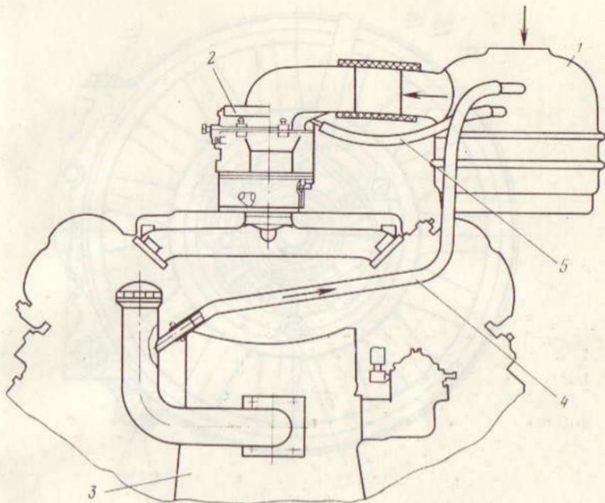
Рис. 22. Схема отсоса картерных газов и вентиляции поплавковой камеры карбюратора:
