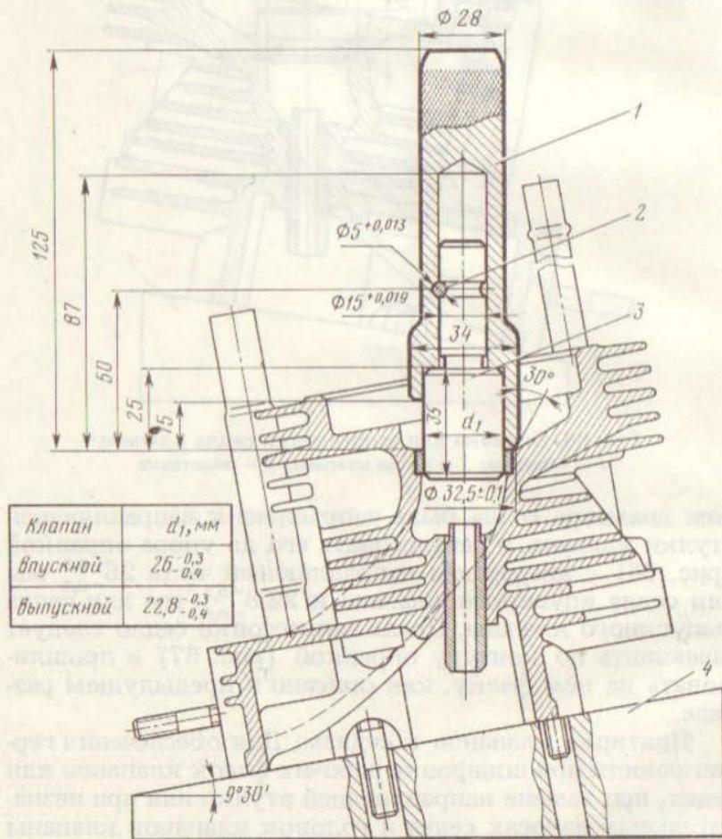
Рис. 67. Оправка для зачеканки седла клапана:
