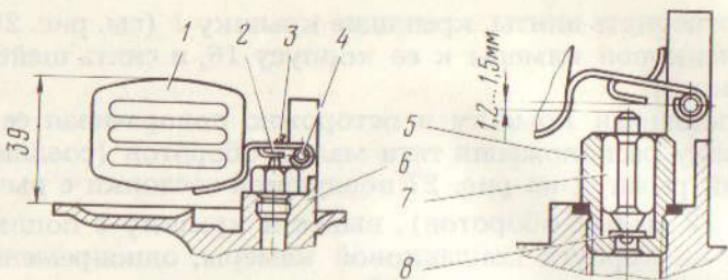
Рис. 77. Поплавок с топливным клапаном:
