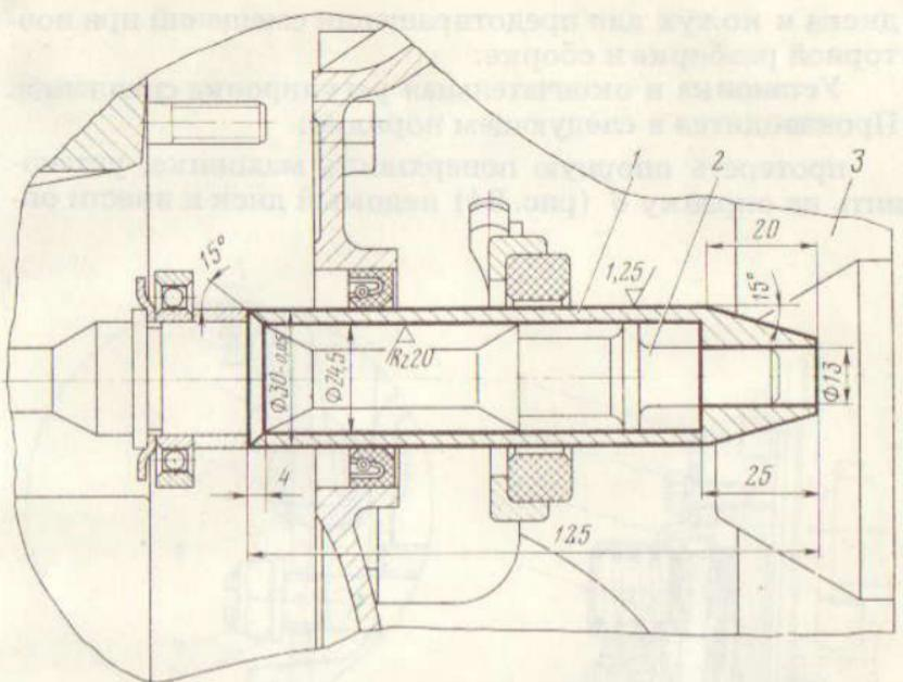
Рис. 83. Оправка для установки картера сцепления в сборе с манжетой на картер коробки передач:
