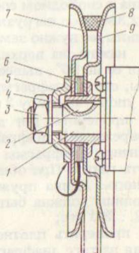
Рис. 74. Устройство для натяжения ремня вентилятора, работающего на нагнетание двигателя МeMЗ-966Г:
