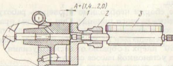
Рис. 76. Приспособление для замера выступания штанги привода бензонасоса:
