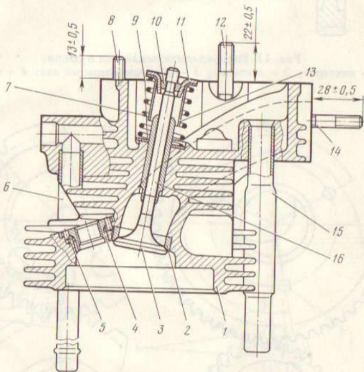
Рис. 10. Головка цилиндров с клапанами в сборе:
