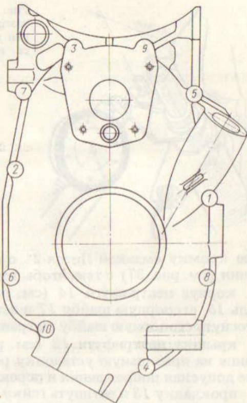
проверить боковой зазор в зацеплении ведущей шестерни и шестерни валика привода, который должен быть 0,05...0,27 мм, он обеспечивается подбором ведущей шестерни 965—1011228, которая изготавливается с различной толщиной зуба по хорде (ниже приведены толщины с разделением на группы и цвета маркировки групп):
