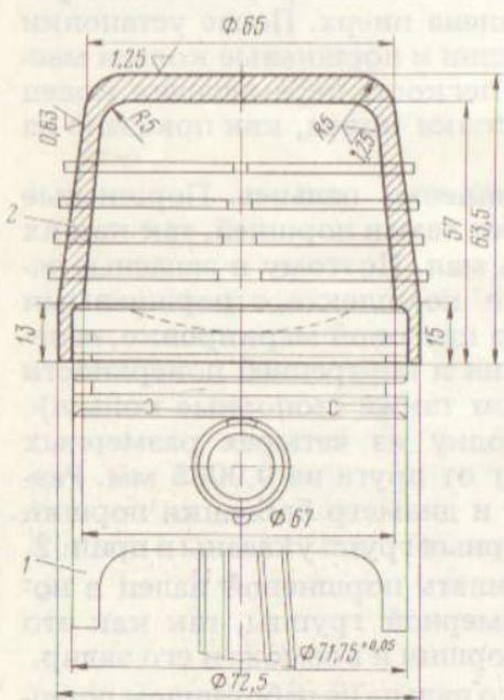
Рис. 56. Оправка для надевания на поршень поршневых колец:
