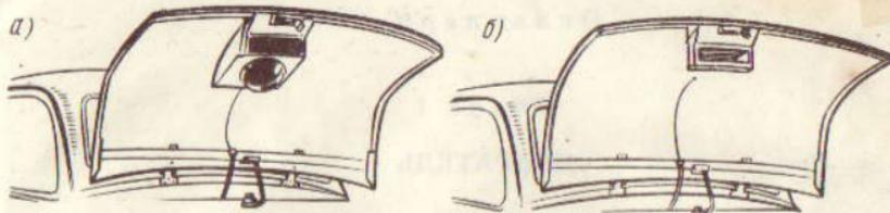
Рис. 100. Капот моторного отсека автомобиля ЗАЗ-965А до переделки (а) и после (б)
