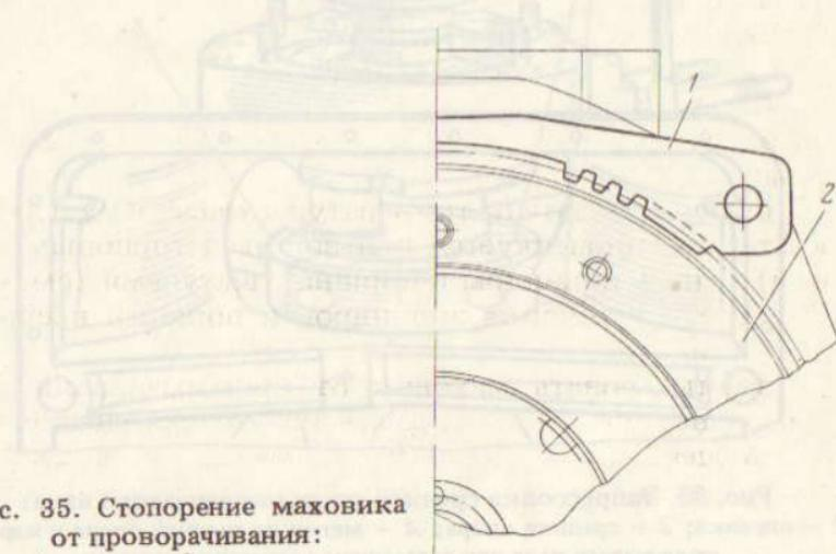
Рис. 35. Стопорение маховика от проворачивания:
