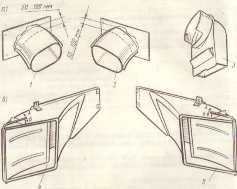
Рис. 98. Воздухопритоки моторного отсека автомобиля до переделки (а) и после (б); заводские обозначения деталей: 1 - 966-5629014; 2 - 966-5629015; 3 - 966-1300010; 4 - 966-5629021Б; 5 - 5629020Б; А - положение "Лето"; Б - положение "Зима"
