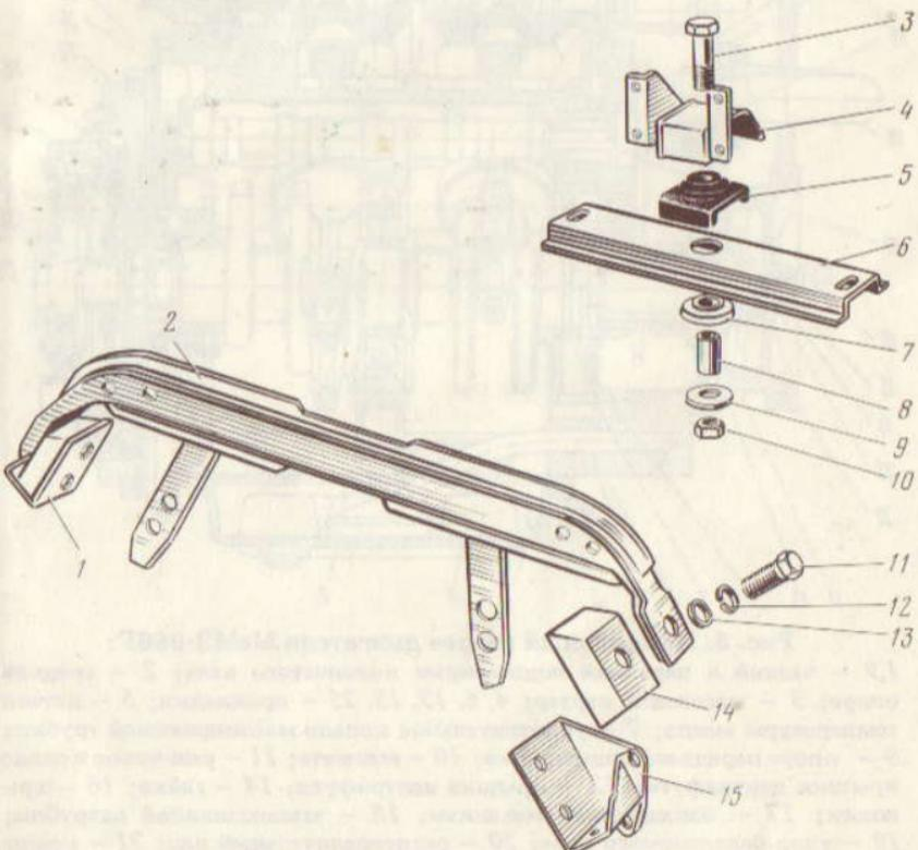
Рис. 2. Подвеска силового агрегата:
