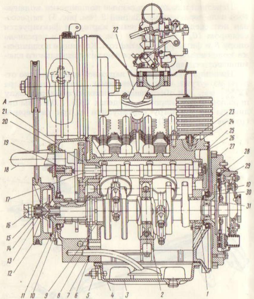
Рис. 3. Продольный разрез двигателя МeMЗ-966Г:
