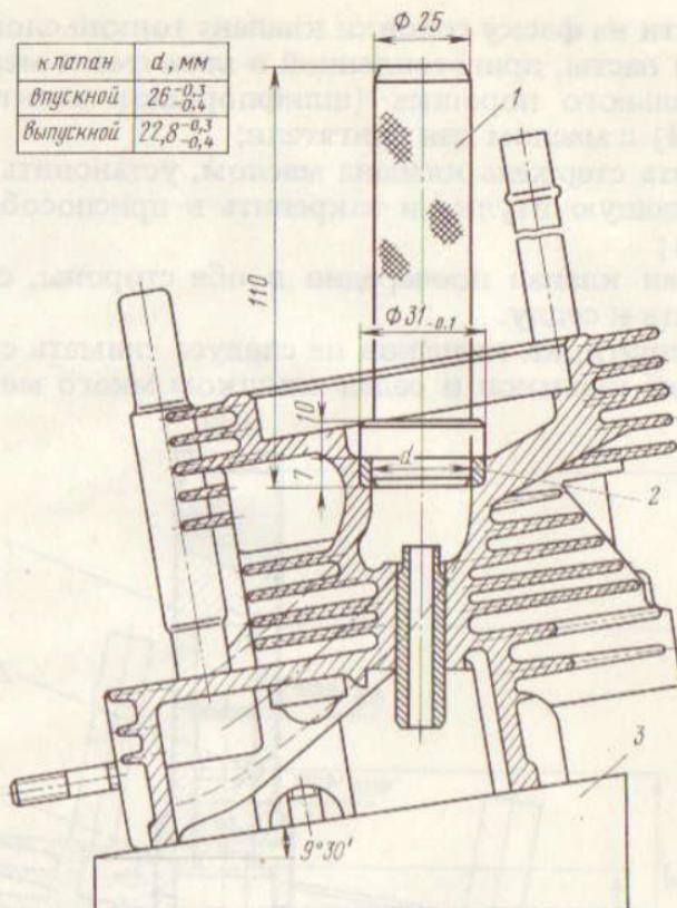
Рис. 66. Оправка для запрессовки седла клапана:
