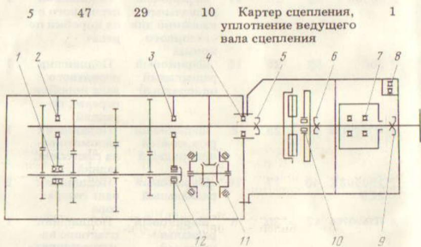
Рис. 97. Схема расположения подшипников и манжет силового агрегата
