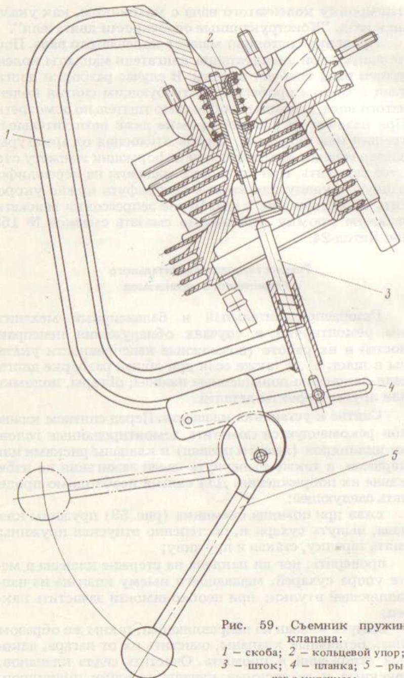
Рис. 59. Съемник пружин клапана:
