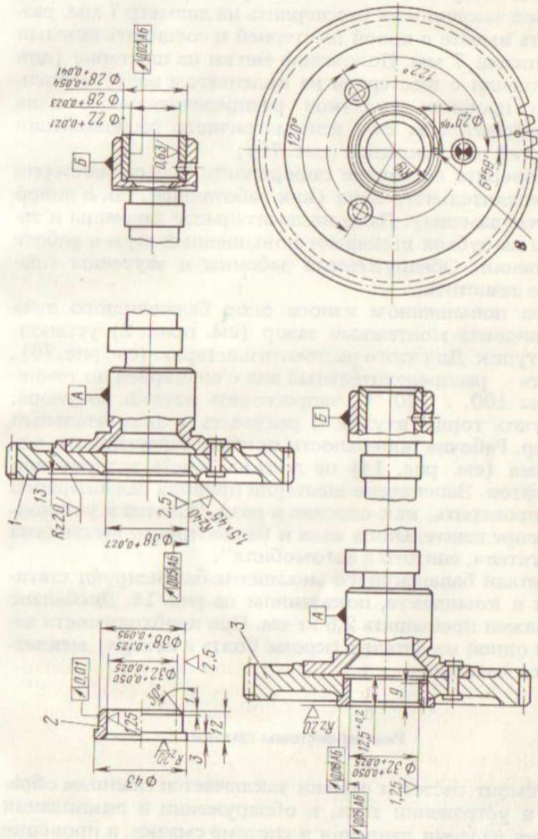
Рис. 70. Растика шестерни распределительного вала под ремонтную втулку:
