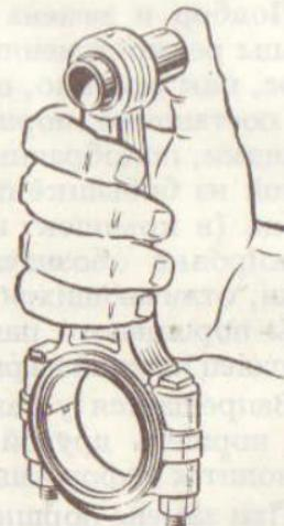
Рис. 57. Проверка правильности подбора поршневого пальца к втулке верхней головки шатуна
