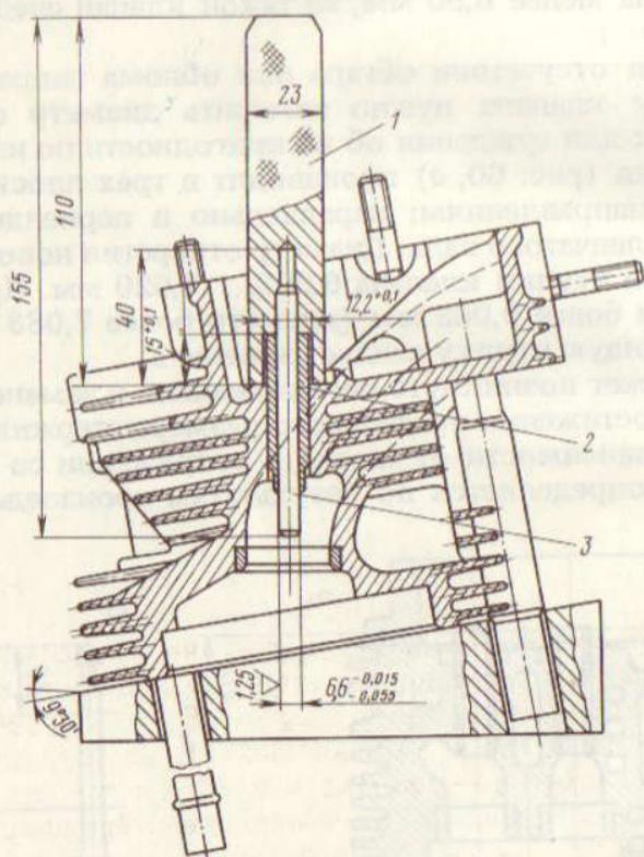
Рис. 61. Оправка для запрессовки направляющих втулок клапанов:
