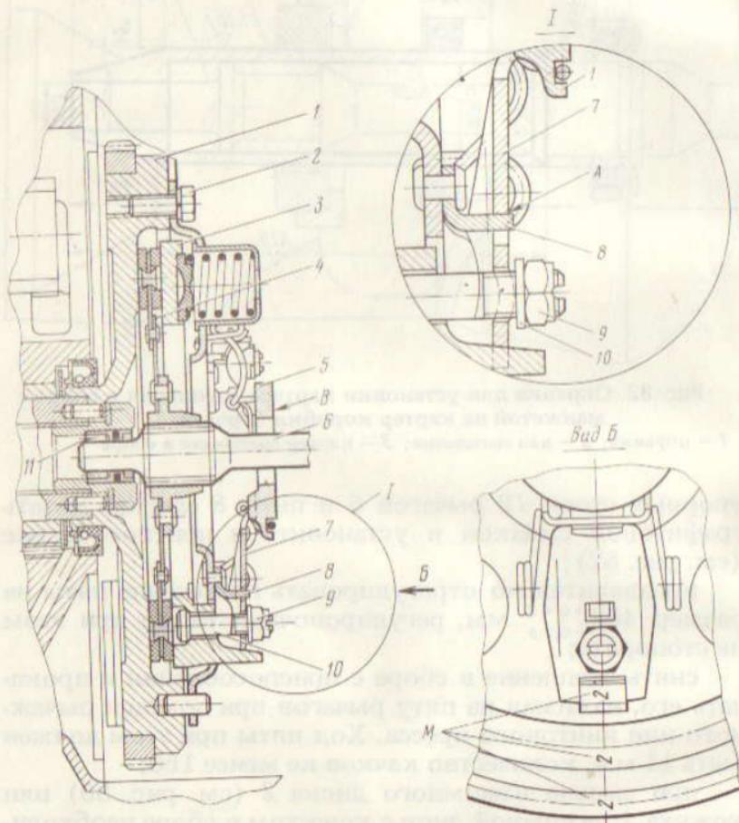
Рис. 84. Установка ведомого диска сцепления с помощью оправки:
