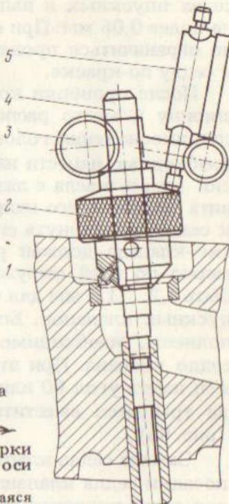
ским приводом (рис. 63). Машина должна быть снабжена набором абразивных кругов с конусами 60, 90, 120°, наружным диаметром 27...28 мм и набором специальных оправок, вставляемых в отверстия направляющих втулок, и приспособлением для правки абразивных кругов.
