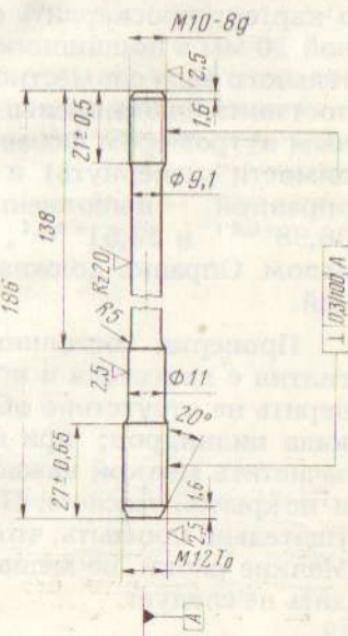
Рис. 49. Шпилька крепления головок цилиндров (ремонтная). Сталь 40Х. Твердость HRC 23...29
