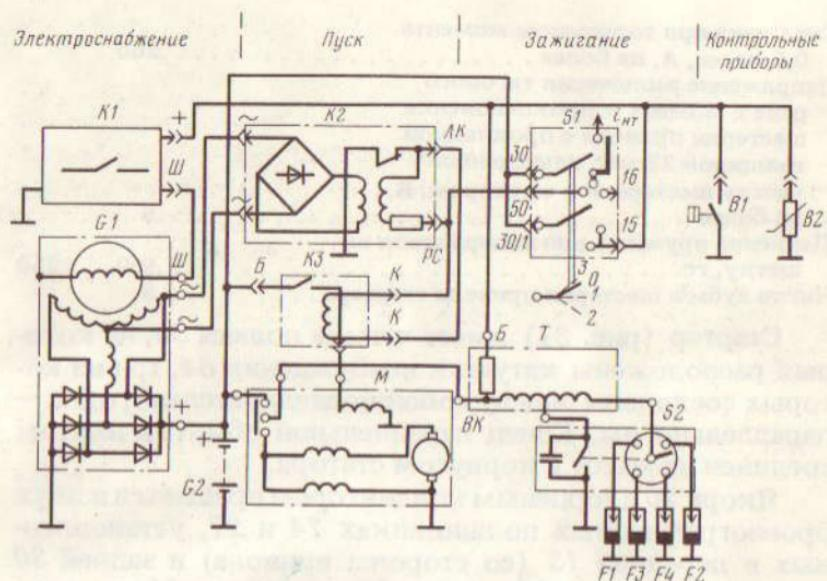
Рис. 30. Схема электрических соединений двигателя:
