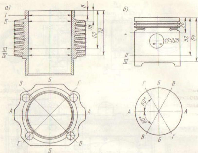
Рис. 51. Схема замера:
