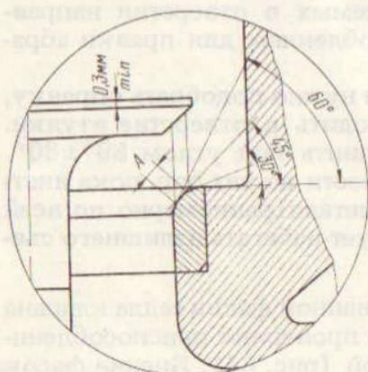
Рис. 65. Углы шлифовки седла клапана:
