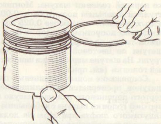
устанавливают радиальный расширитель 5 (см. рис. 7), нижний диск 3, осевой расширитель 4 и верхний диск, затем устанавливают нижнее и верхнее компрессионные кольца. При установке компрессионных колец прямогольная фаска, выполненная на внутренней поверхности, должна быть обращена вверх. После установки колец нужно смазать поршни и поршневые кольца маслом и еще раз проверить легкость перемещения колец в канавках и расставить стыки колец, как показано на рис. 7.
