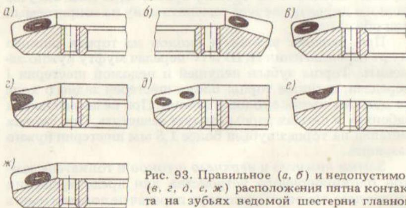
Рис. 93. Правильное (а, б) и недопустимое (в, г, д, е, ж) расположения пятна контакта на зубьях ведомой шестерни главной передачи:
