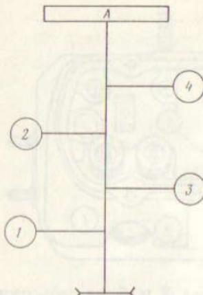
Рис. 42. Порядок нумерации цилиндров двигателя:
