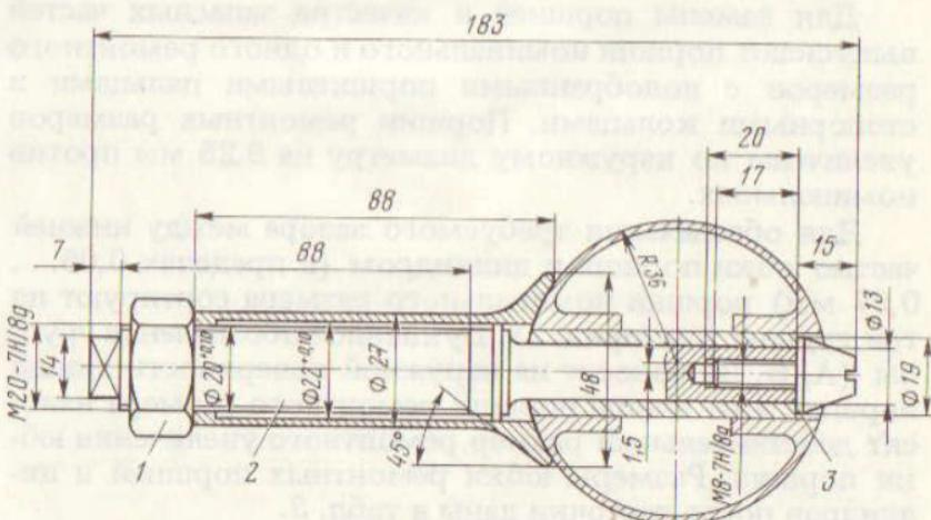
Рис. 52. Приспособление для выпрессовки поршневого пальца:
