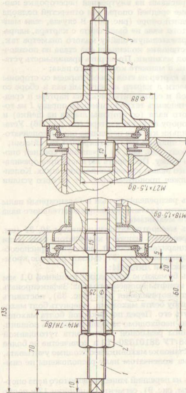
Рис. 37. Оправка для установки манжет коленчатого вала:
