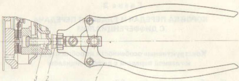
Рис. 85. Клещи для фиксации регулировочных гаек пальцев сцепления
