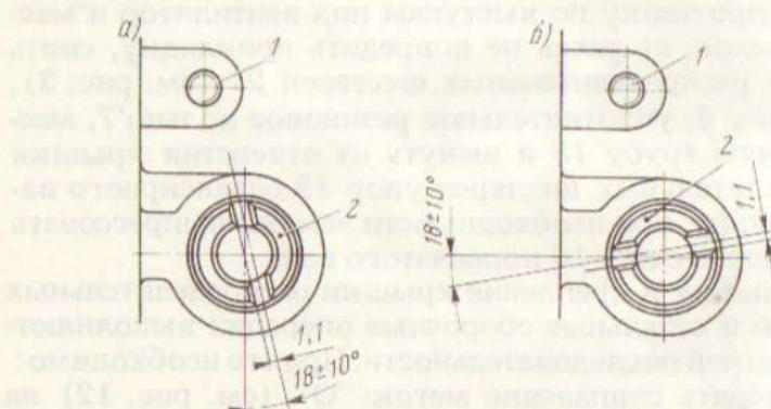
Рис. 44. Установка валика привода масляного насоса и прерывателя-распределителя:
