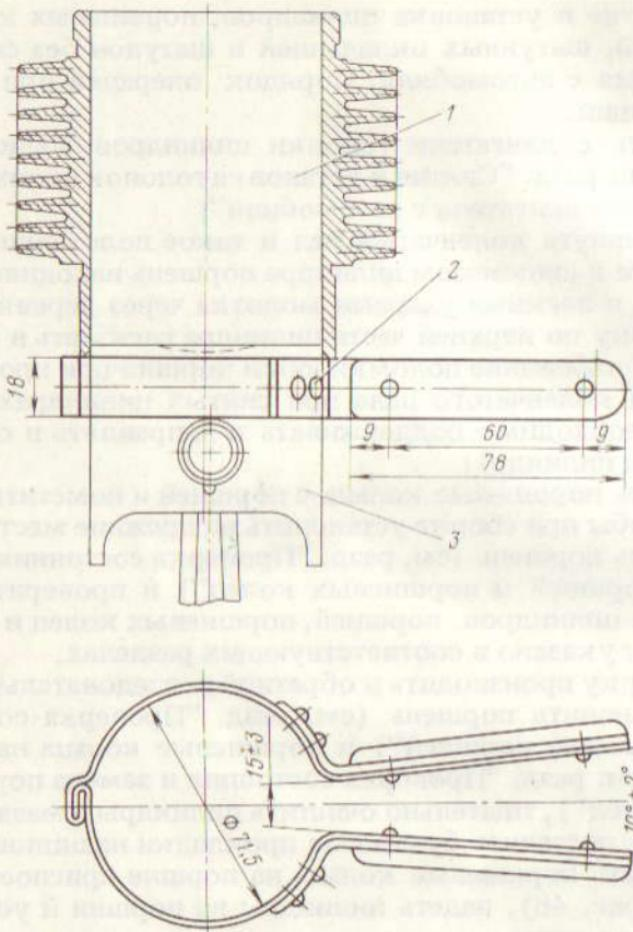
Рис. 48. Приспособление для обжима поршневых колец:
