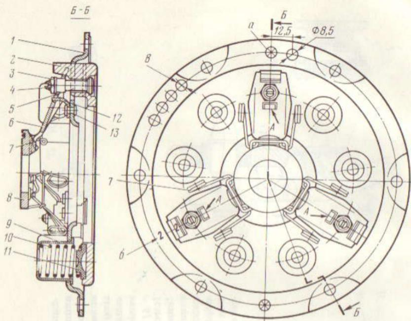
Рис. 80. Нажимной диск сцепления с кожухом в сборе:
