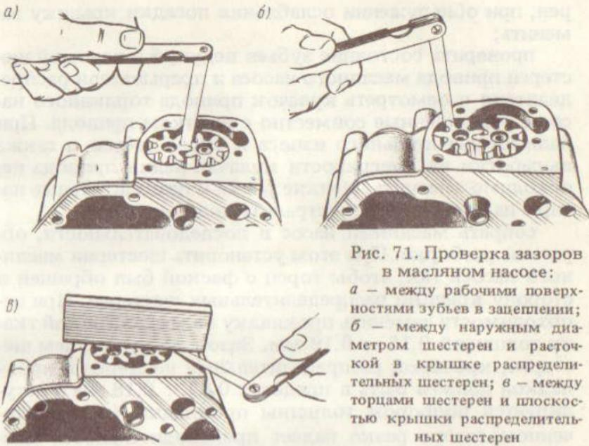
Рис. 71. Проверка зазоров в масляном насосе:
