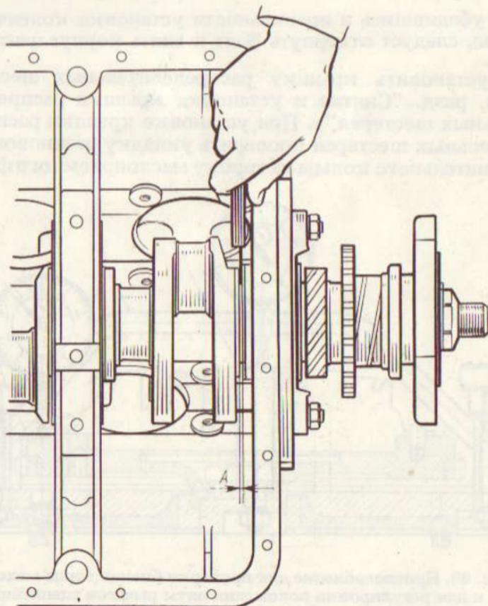
Рис. 38. Проверка осевого перемещения коленчатого вала:
