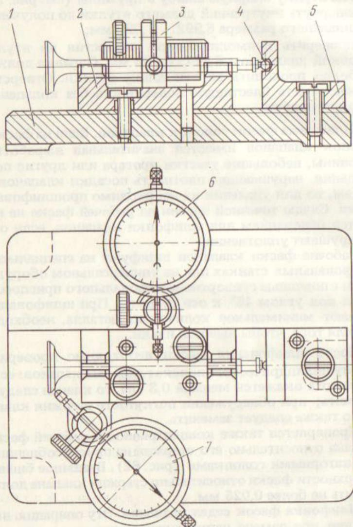
Рис. 62. Проверка клапана на концентричность рабочей фаски головки и стержня:
