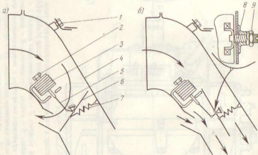
Рис. 24. Схема устройства и работы автоматического регулятора температуры двигателя МeMЗ-966B:
