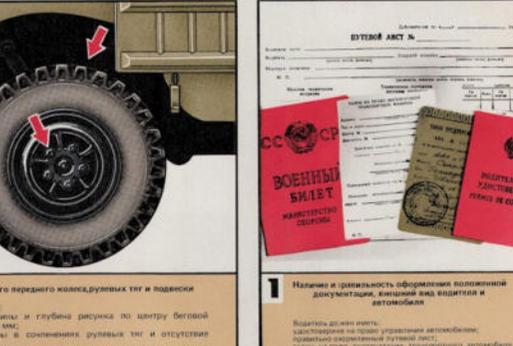
**2** Состояние левого переднего колеса, рулевых тяг и подвески
